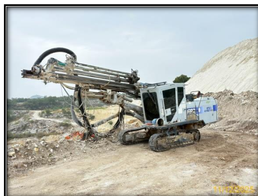
รูปที่ 2-36 เครื่องเจาะรुरुเบิด
