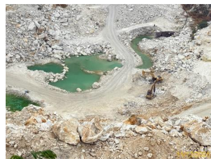
รูปที่ 2-53 ใช้พื้นที่ต่ำสุดของหน้าเหมืองเป็นบ่อรับน้ำ (Sump) เพื่อรองรับน้ำไหลบ่าผิวดินจากน้ำฝนที่ตกลงสู่บริเวณพื้นที่หน้าเหมือง
