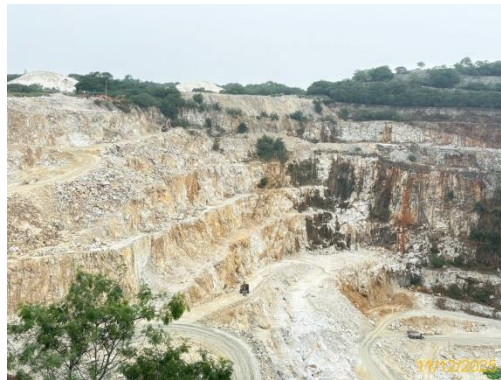
รูปที่ 2-51 เปิดการทำเหมืองเพื่อการผลิตแร่ตามที่กำหนดในแผนผังโครงการทำเหมือง การเปิดหน้าเหมืองจะต้องเป็นแบบ (Benching method)
